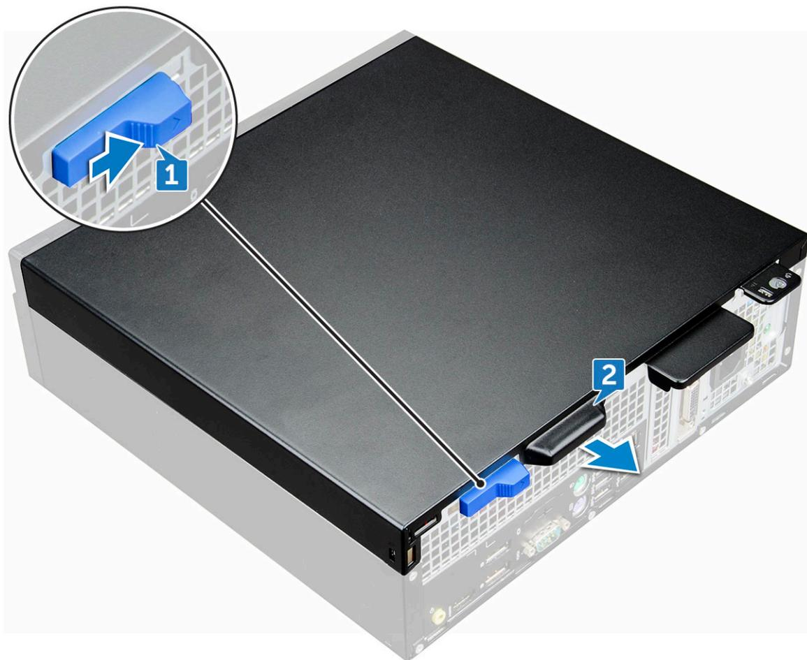
3. Levante a tampa para removê-la do computador.
